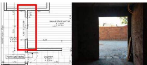
Figura 03 – Muretas antes e depois da solução desenvolvida em obra para solução da inclinação não prevista.
