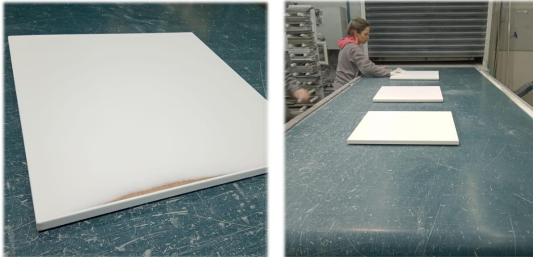
Figura 9 e 10: Peça com região “queimada” a esquerda e peças sendo encaminhadas para aplicação de cor junto ao robô.
